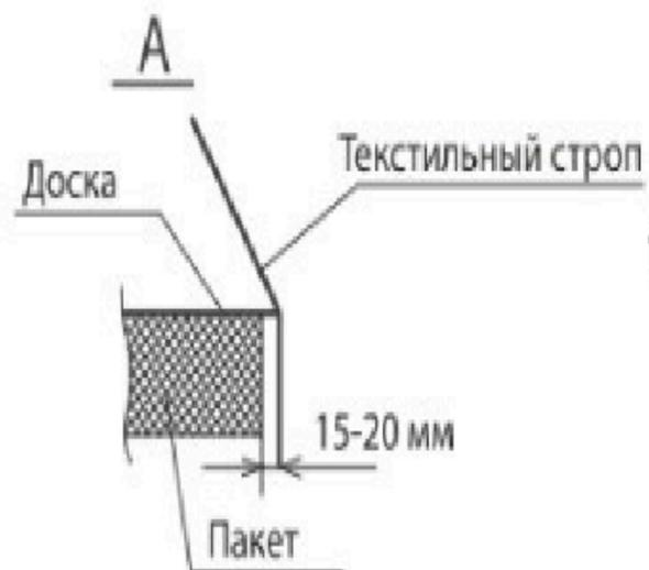
Схема строповки пакета панелей длиной свыше 6 м при помощи траверсы представлена на Рис.2
