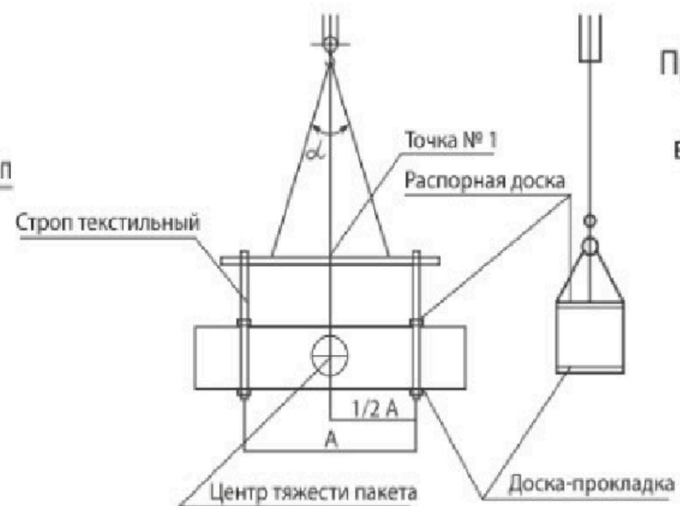
При строповке пакета длиной свыше 6000 мм в точке №1 устанавливается дополнительный строп.
